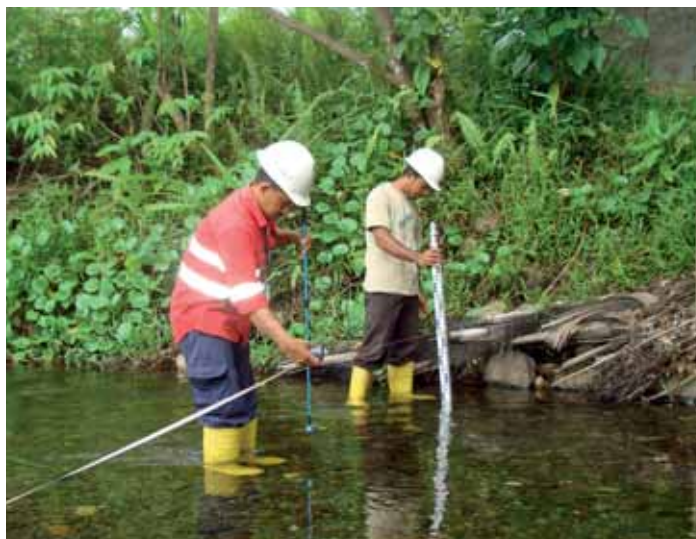
Relevé des hauteurs d'eau et des débits sur les rivières du projet Weda Bay Nickel.
