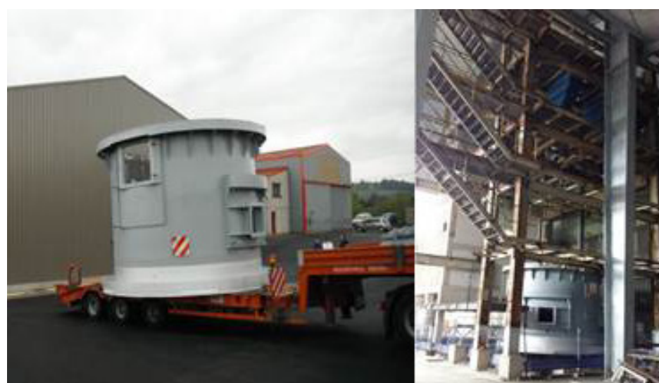
Enveloppe métallique du four électrique à laitier
