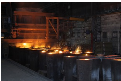
Alliages en sortie de four
